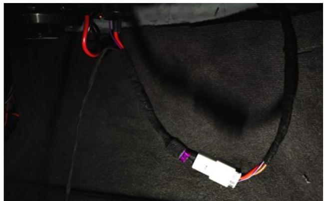
**Schließen Sie Stecker (A) des Y-Kabels an den Gebläsemotor an. Stecken Sie den originalen Stecker in Anschluss (B).**
