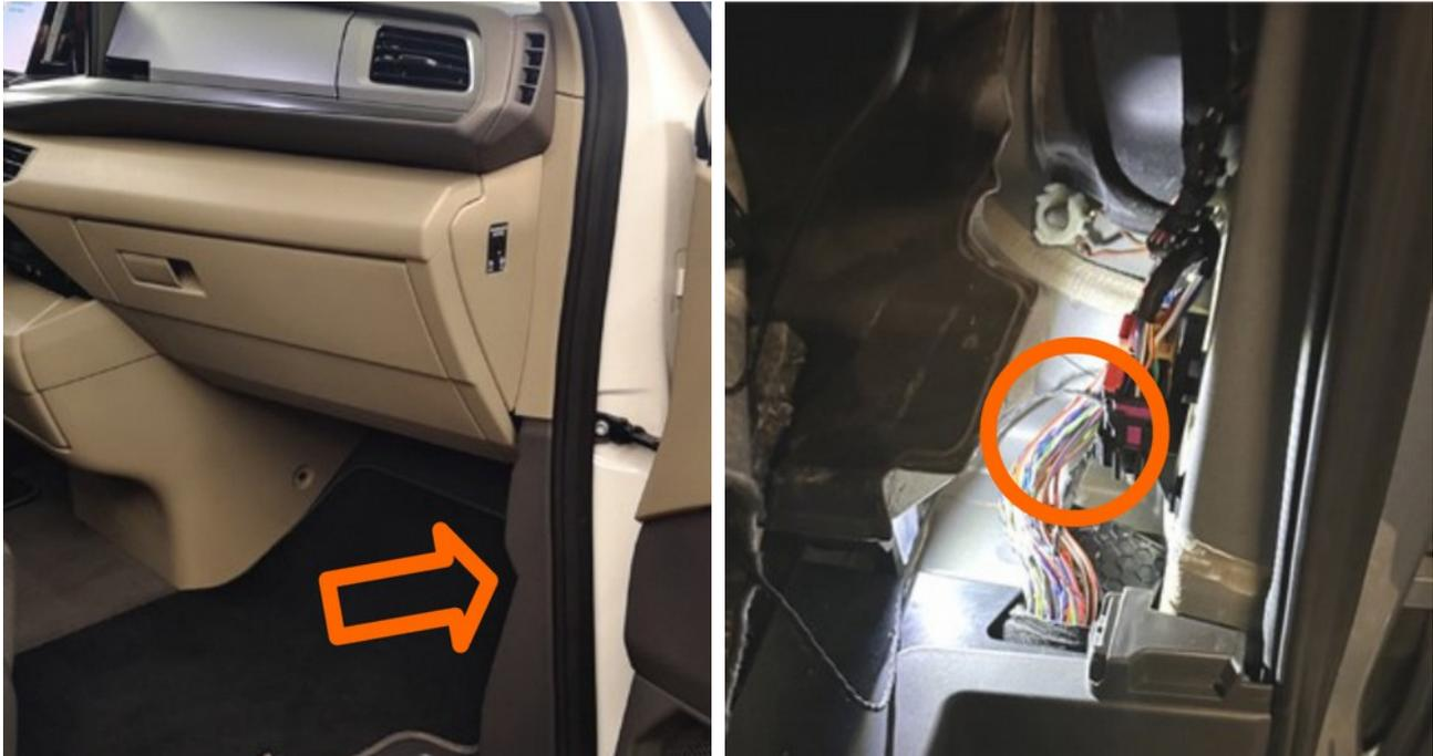
**Entfernen Sie die untere Verkleidung der rechten A-Säule.**
