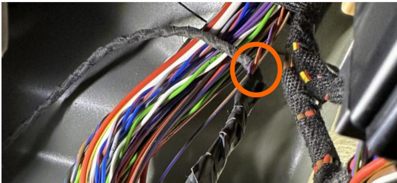
**Suchen Sie im originalen Kabelbaum die verdrehte or/br, li Leitung. Löten Sie an die lila Leitung die or/li Leitung des Aufrüstsatz an. Löten Sie an die originale or/br Leitung die or/br Leitung des Aufrüstsatz an. Isolieren Sie die Lötstellen.**
