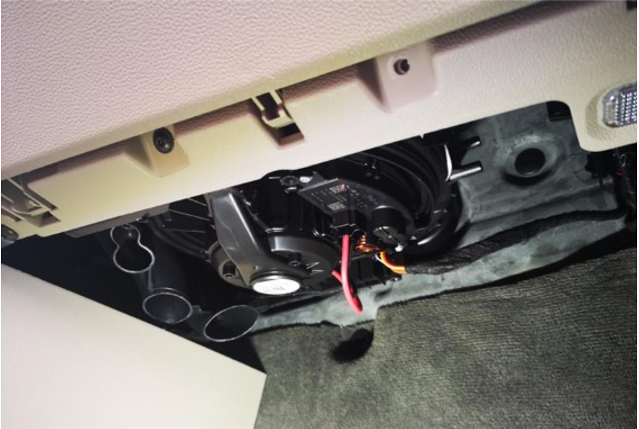
**Das Bild zeigt die Unterseite des Handschuhfachs nach dem Entfernen der Kunststoffabdeckung. Die Abdeckung ist nur gesteckt und kann vorsichtig nach unten abgezogen werden. Entfernen Sie den schwarzen, 4-poligen Stecker am Gebläsemotor.**
