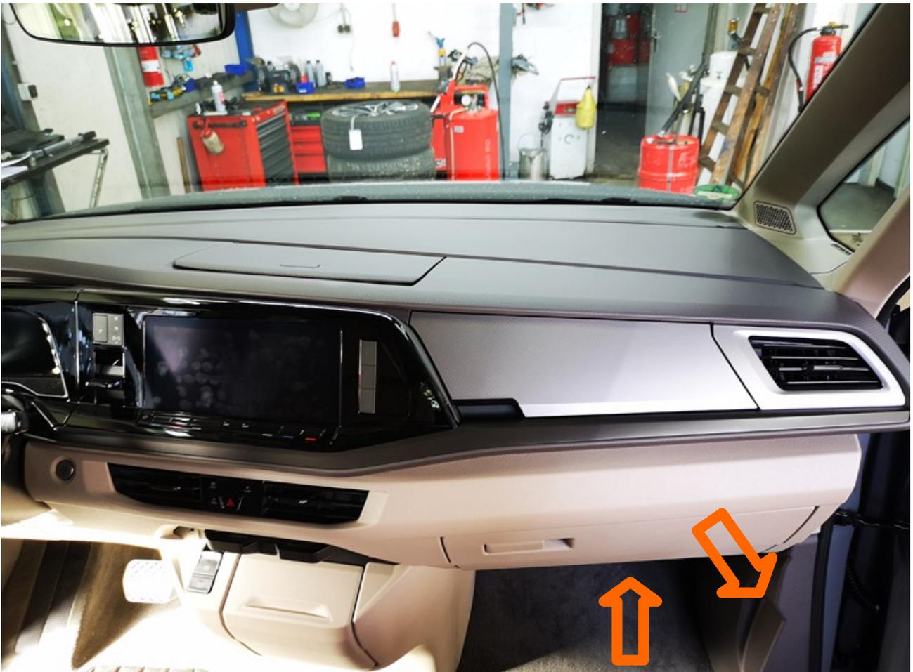
**Die Aufrüstung wird an den vorhandenen Stecker des Gebläsemotors hinter dem Handschufach sowie an den Multimedia CAN-BUS angeschlossen.**
