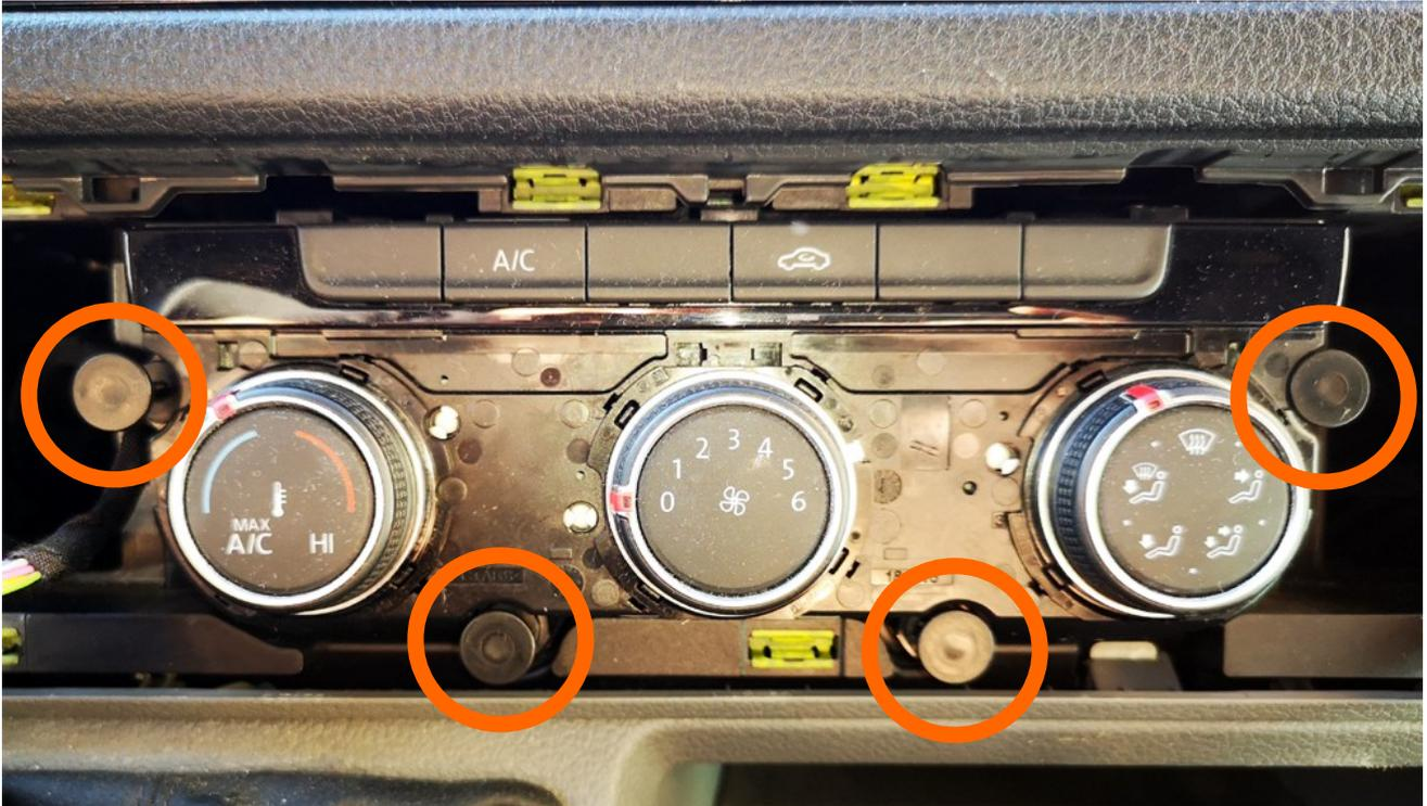
**Entriegeln Sie die 4 Spreizstifte. Ziehen Sie dazu den mittleren Teil etwas nach vorn.**
