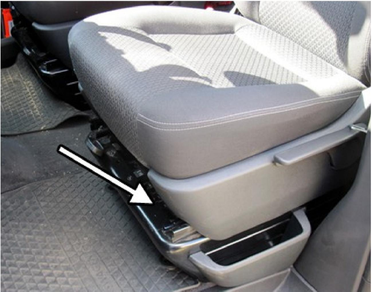
**Die Zuheizeraufrüstung wird an den vorhandenen Stecker des Zuheizers unter dem Fahrersitz angeschlossen. Die Ansteuerung des Gebläses erfolgt am Stecker auf der Rückseite des Klimaedienteils.**
