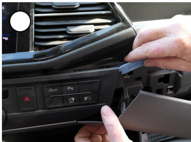
**Entfernen Sie die untere Verkleidung des Armaturenbretts.**
