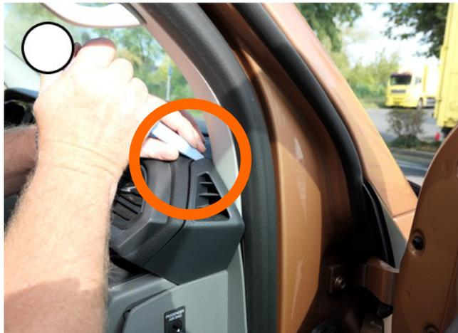
**Entfernen Sie die rechte Abdeckung des Armaturenbretts und den Luftausströmer.**
