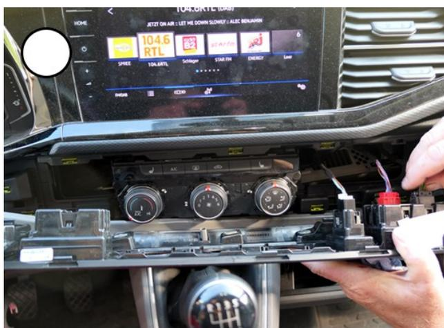
**Entfernen Sie die Verkleidung des Klimabedienteils.**
