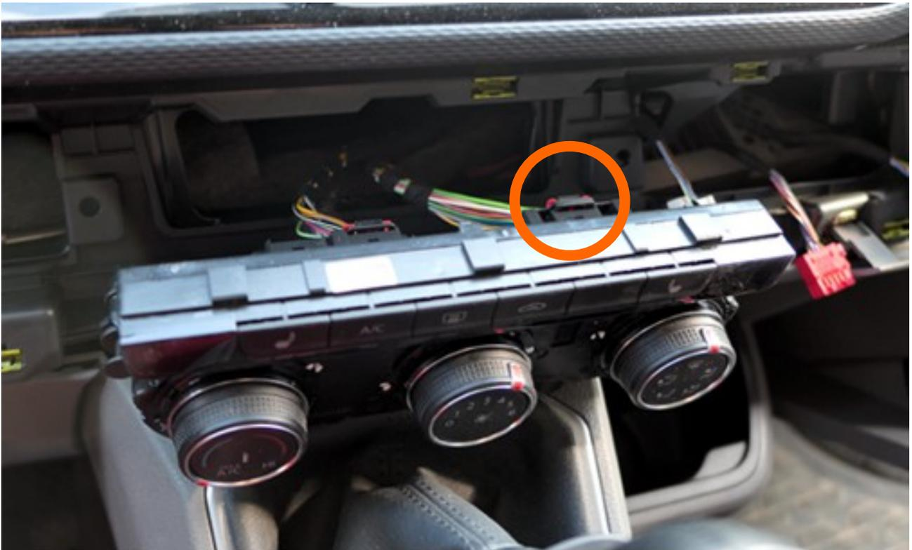
**Der „Smart Switch“ wird mit der gelb/schwarzen Leitung an den 20-poligen Stecker auf der Rückseite des Klimabedienteils angeschlossen.**
