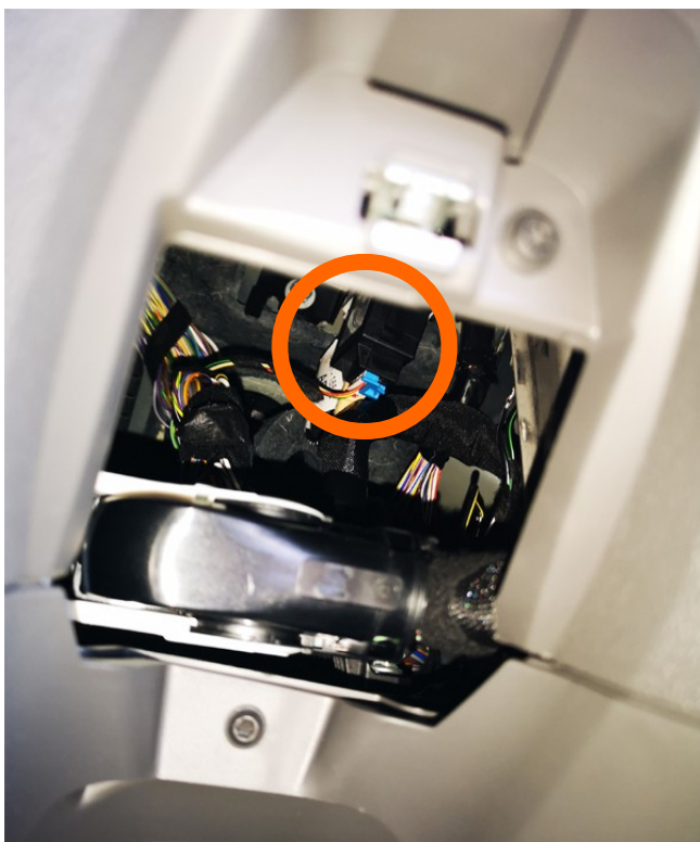
Entfernen Sie den blauen, 6-poligen Stecker. Unplug the blue, 6-pole connector.
