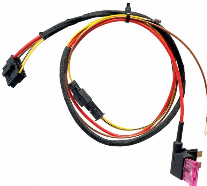
**Die Leitung wird an den Stecker des Klimasteuergeräts sowie an Masse und +12v angeschlossen.**
