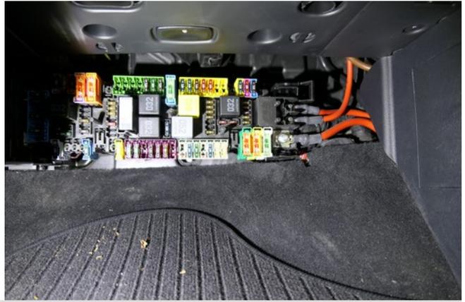
**Entfernen Sie die Abdeckung des Sicherungsträgers.**
