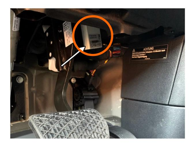
Der Empfänger der Funkfernebdienung befindet sich im Fahrerfußraum oberhalt der Pedalen.
