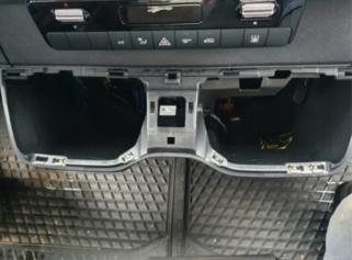
Im Boden des Becherhaltes befindet sich je eine Schraube. Wenn Sie diese entfernt haben können Sie den Einsatz nach oben abziehen.
