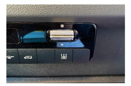
Die APP-Steuerung wird an den Stecker auf der Rückseite des Klimabedienteils angeschlossen. Dazu muss das Klimabedienteil ausgebaut werden.
