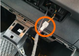
Lösen Sie den schwarzen, 8-poligen Stecker auf der Rückseite des Klimabedienteils. Stecken Sie diesen dann in die passende Buchse am Y-Kabel. Stecken Sie den weißen, 8-poligen Stecker des Y-Kabels in die Buchse des Klimabedienteils.
