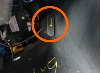
Verlegen Sie die Leitung des Y-Kabels mit dem schwarzen, 14-poligen Stecker nach unten in den Schacht des Becherhalters. Schließen Sie den 14-poligen Stecker an die APP-Steuerung ab. Befestigen Sie die APP-Steuerung an der Seitenwand.
