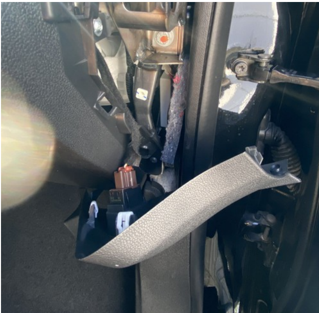
Entfernen Sie die Verkleidung an der rechten Seite des Armaturenbretts. Dismount the cover at the right side of the dashboard.
