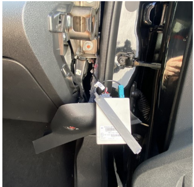
Entfernen Sie die Verkleidung an der rechten Seite des Armaturenbretts. Dismount the cover at the right side of the dashboard.
