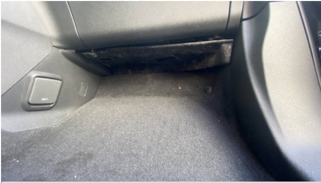
Entfernen Sie die Verkleidung unter dem Handschuhfach. Dismount the cover beneath the glove compartment.
