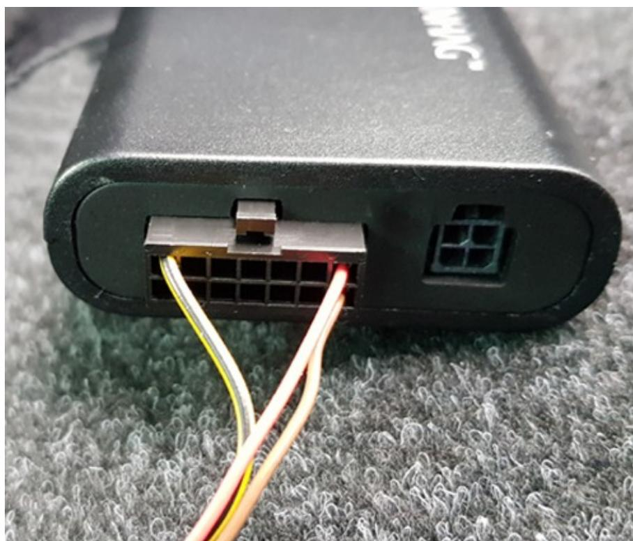
**Schließen Sie den schwarzen, 14-poligen Stecker des Y-Kabels an die APP-Steuerung an.
