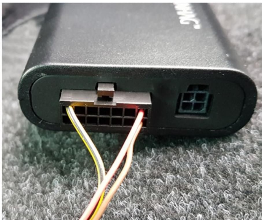
**Schließen Sie den schwarzen, 14-poligen Stecker des Y-Kabels an die APP-Steuerung an.**
