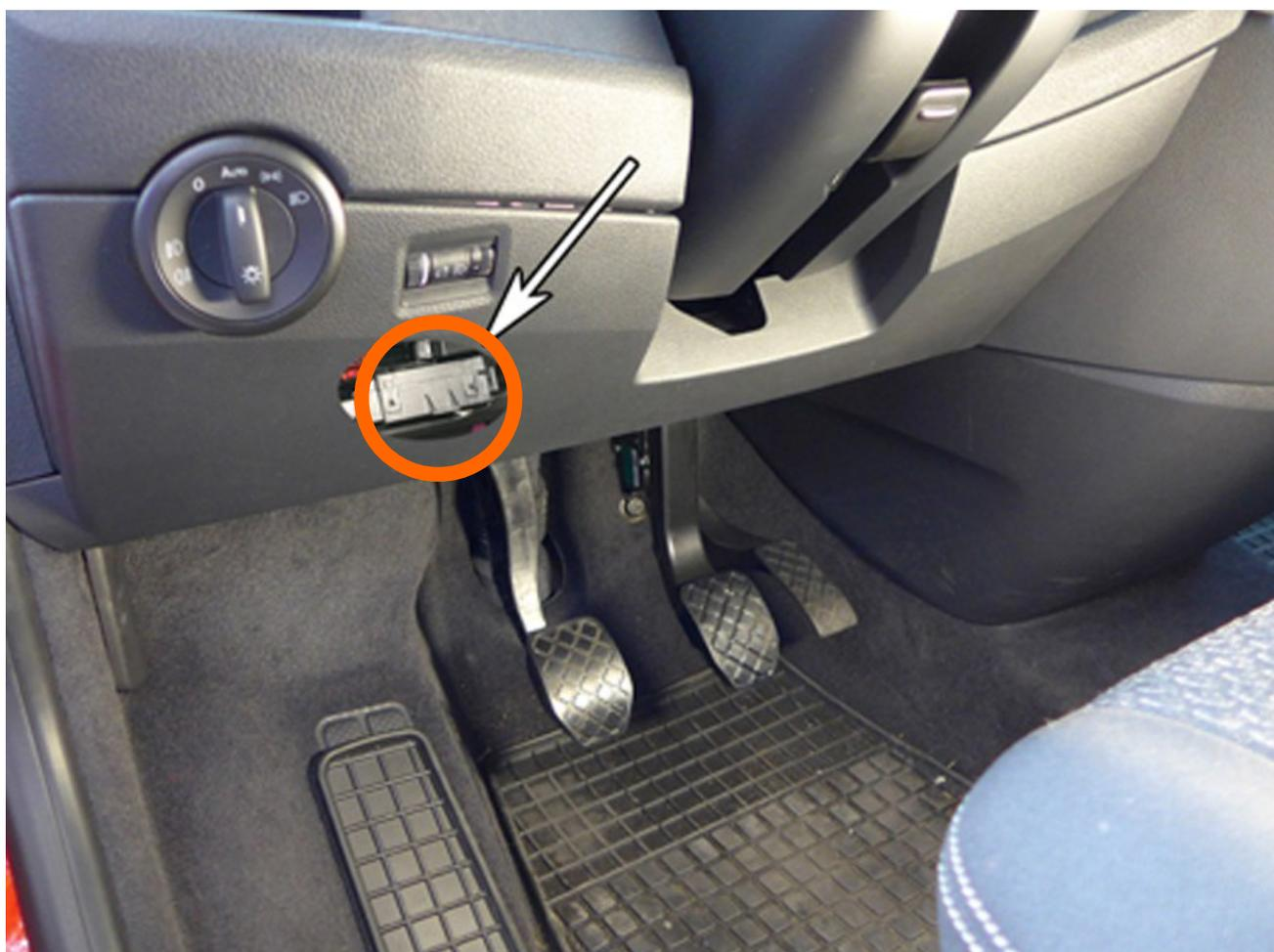
**Die APP-Steuerung wird mit einem Y-Kabel an den vorhandenen Empfänger der Funkfernbedienung angeschlossen.**
