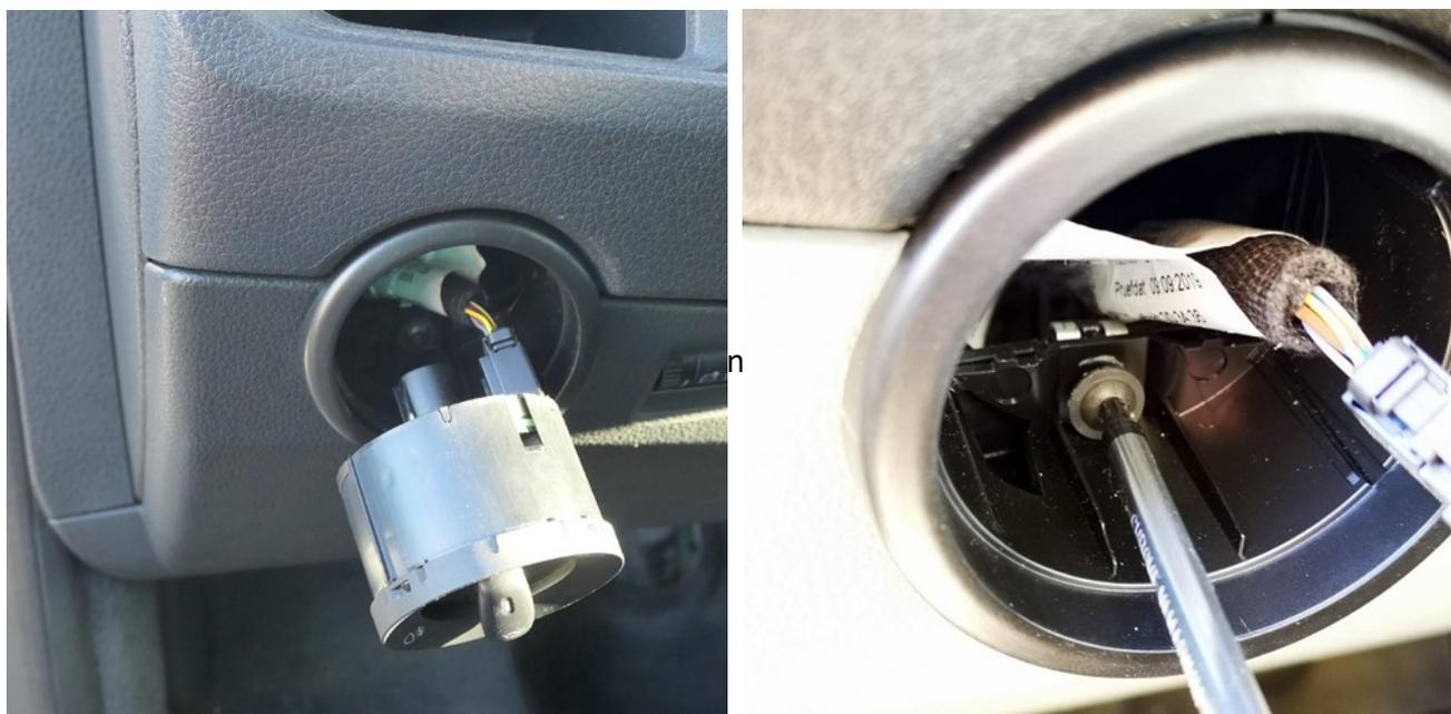
**Demontieren Sie den Lichtschalter: Drücken Sie dazu den Schalter ein und drehen Sie ihn in gedrückter Position nach links. Ziehen Sie dann den Schalter nach vorne heraus. Entfernen Sie den Stecker und die Torx-Schraube.**
