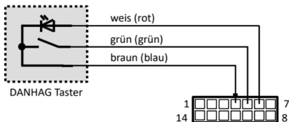
14pol. Buchse der GSM-Fernsteuerung.
